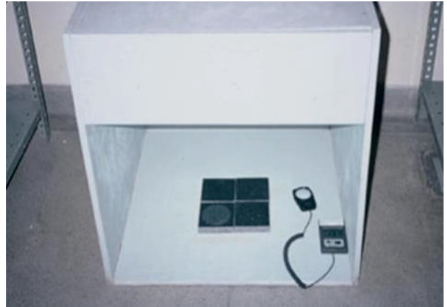
Caixa com iluminação controlada para avaliação de resultado do ensaio de resistência à abrasão superficial (Foto: Eleno de Paula Rodrigues).
