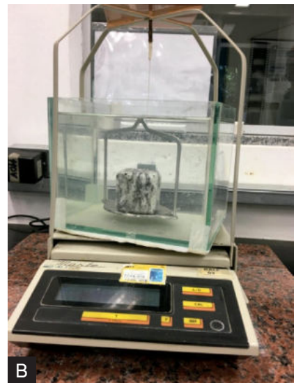
B (B) Determinação de peso submerso (Foto obtida no IPT).
