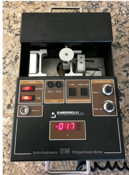
Equipamento utilizado para determinação de coeficiente de atrito dinâmico (Foto: Eleno de Paula Rodrigues).
