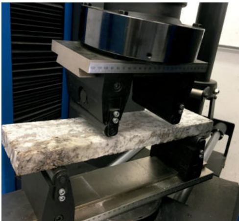
Corpo de prova posicionado em prensa hidráulica, antes do ensaio. Notar que o corpo de prova está apoiado em dois cutelos e que a força é também aplicada com dois cutelos, por isso também designado de flexão quatro pontos (Foto obtida no IPT).
