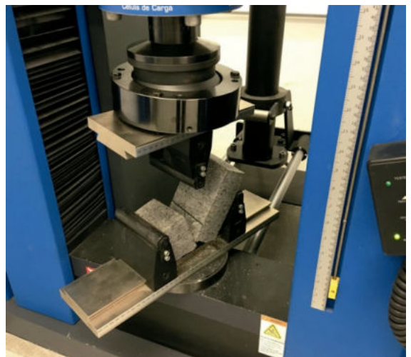
Corpo de prova rompido após a execução do ensaio (Foto obtida no IPT).
