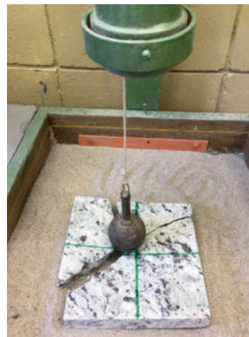
Corpo de prova quebrado após a execução do ensaio (Foto obtida no IPT).
