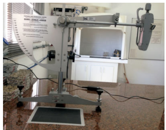
“Pêndulo britânico”: equipamento utilizado para determinação da resistência ao escorregamento (Foto obtida no Cetem).
