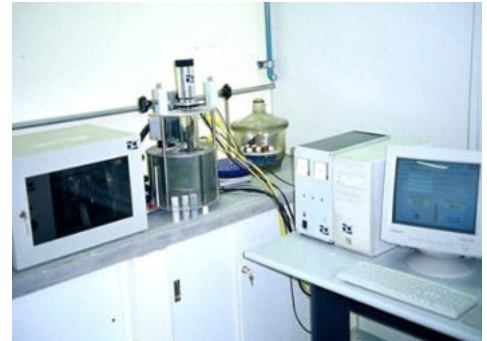
Equipamento para medição da dilatação térmica linear (Foto: Eleno de Paula Rodrigues).
