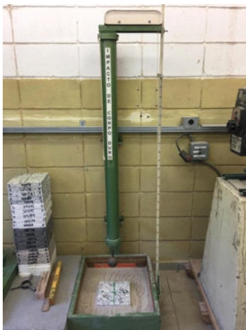
Equipamento montado de acordo com a orientação da norma ABNT NBR 15845-8, próprio para ensaio de resistência ao impacto (Foto obtida no IPT).
