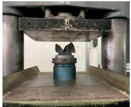
Corpo de prova rompido após a execução do ensaio (Foto obtida no IPT).
