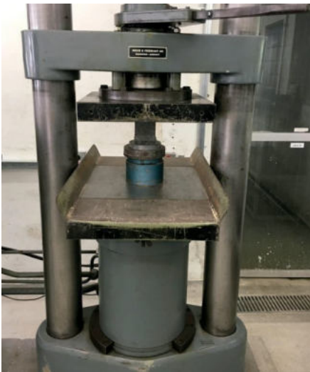
Prensa hidráulica com corpo de prova cúbico, antes do ensaio (Foto obtida no IPT).
