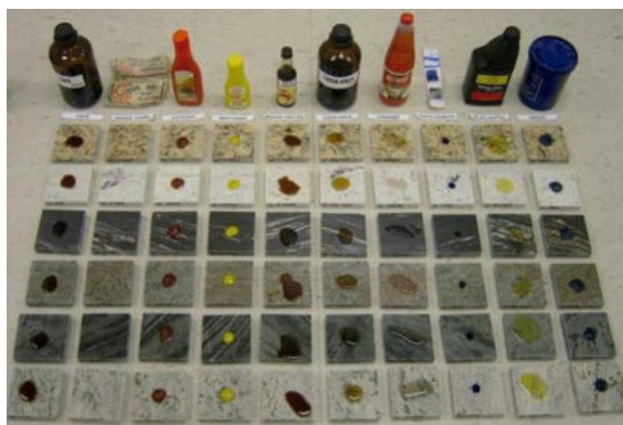
Ilustração de ensaio de resistência ao manchamento (Foto: Eleno de Paula Rodrigues).
