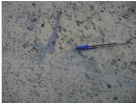
**Foto 23** - Manchas azuis provocadas pelo contato accidental do líquido utilizado como catalizador na resina poliéster (“massa plástica”) durante os trabalhos executados na marmoraria.
