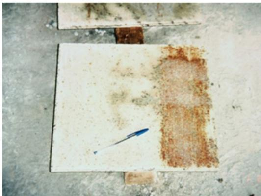
**Foto 31** - Presença de grande quantidade de granalha ferruginosa (oriunda dos trabalhos de serrada dos blocos), em estágio avançado de oxidação, incrustada no tardo de peça de granito.
