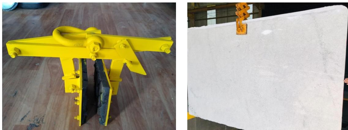
Figura 15 - Modelo de garra (pinça) e sua utilização na movimentação de chapa.
