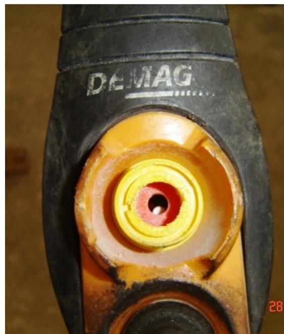
Figura 12 - Botoeira sem dispositivo de segurança (botão de emergência).
