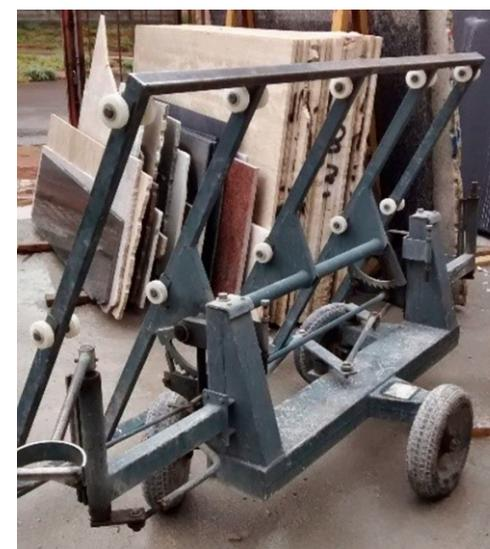
Figura 3 - Carro transportador com basculamento.
