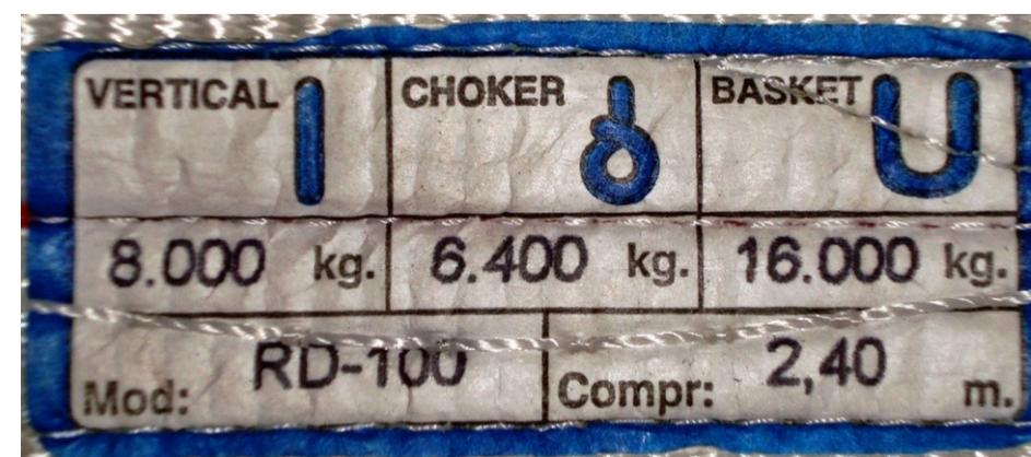
Figura 20 - Informações de capacidade de carga da cinta nas diferentes formas de uso.
