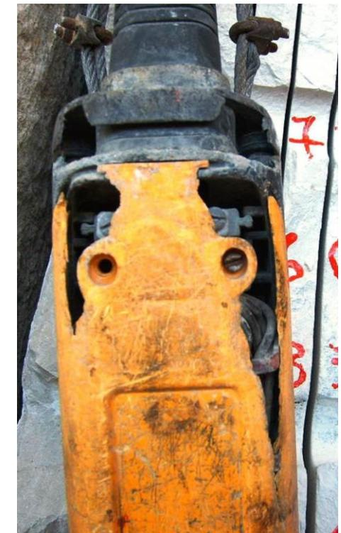
Figura 11 - Botoeira imprópria para uso devido ao desgaste.
