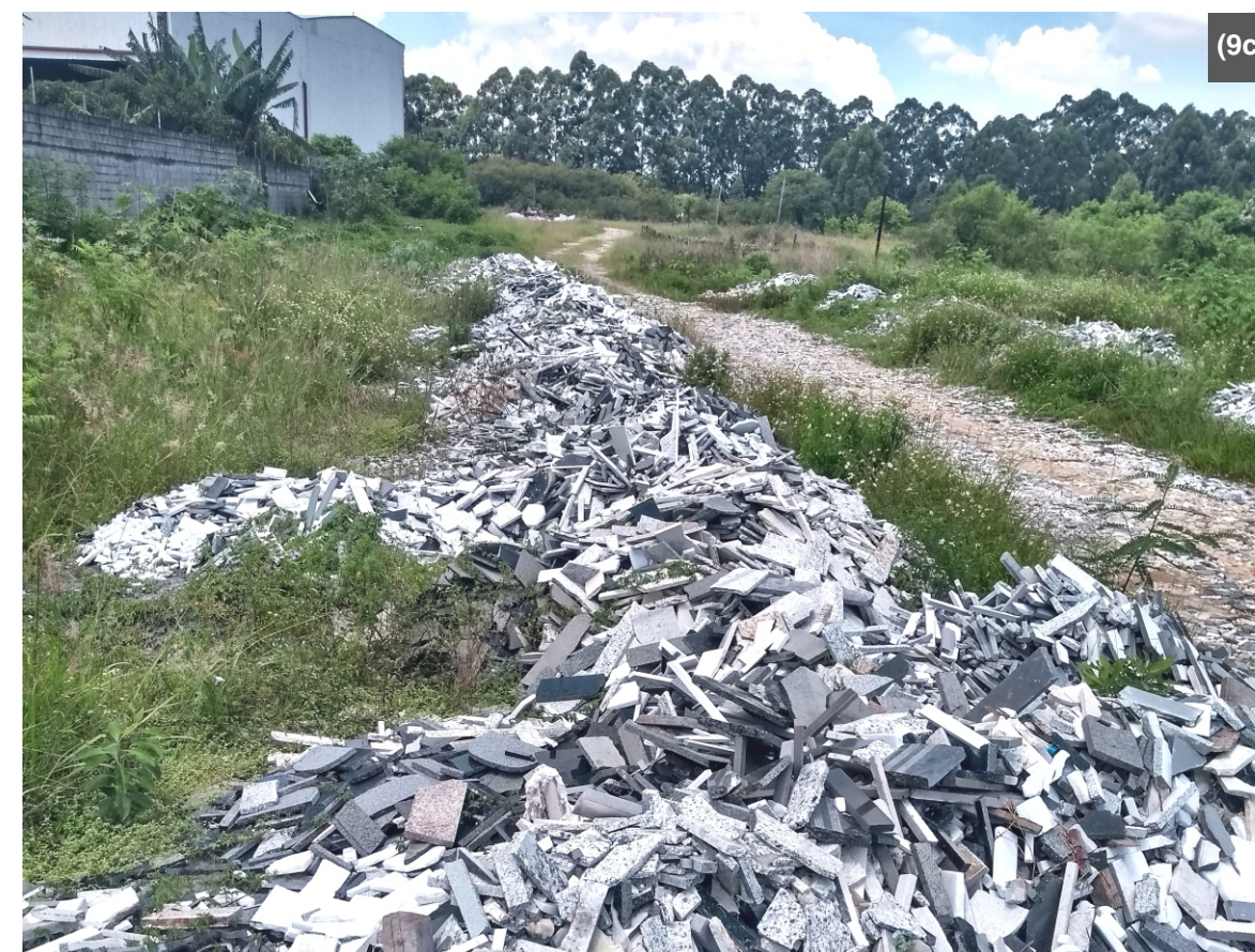
Figura 9 - Exemplos de resíduos gerados na marmoraria: (a) chapa de material homogêneo com veio indesejado; (b) sobras e recortes: grande parte permanece por anos nos pátios das marmorarias, sem destinação; (c) descarte de cacos - resíduo de marmoraria. (Fotos: Álvaro Cintra Jr.)
