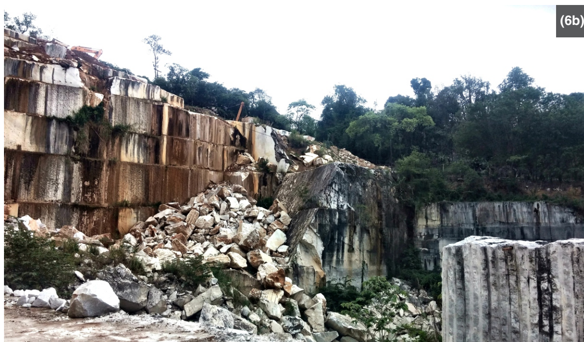
Figura 6 - Exemplos de resíduos gerados durante a extração: (a) extração em matacão; (b) extração por bancadas em maciço rochoso. (Fotos: Jéssica G. Mathielo)
