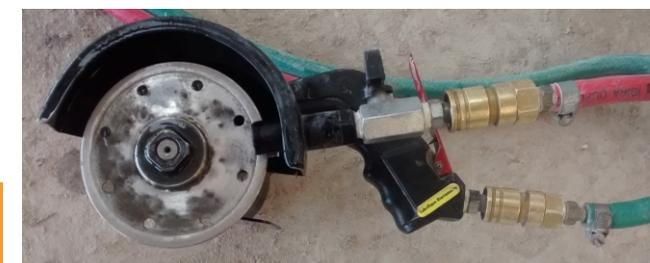
Figura 1 - Exemplo de equipamento utilizado para realizar acabamento e/ou lixamento umidificado.
