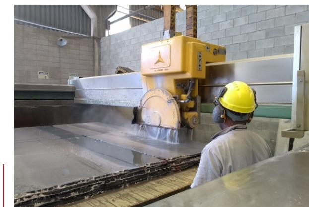
Figura 6 - Operador de serra-ponte (cortador).
