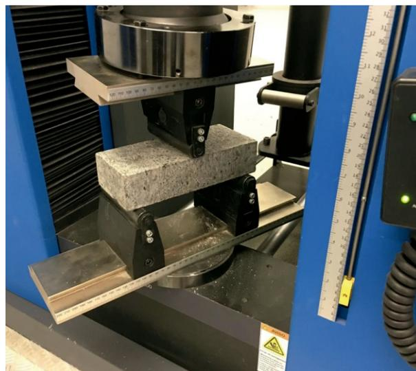
Corpo de prova retangular posicionado em prensa hidráulica, antes do ensaio. Notar que o corpo de prova está apoiado em dois cutelos e que a força é aplicada com um cutelo, por isso também designado de flexão três pontos (Foto obtida no IPT).
