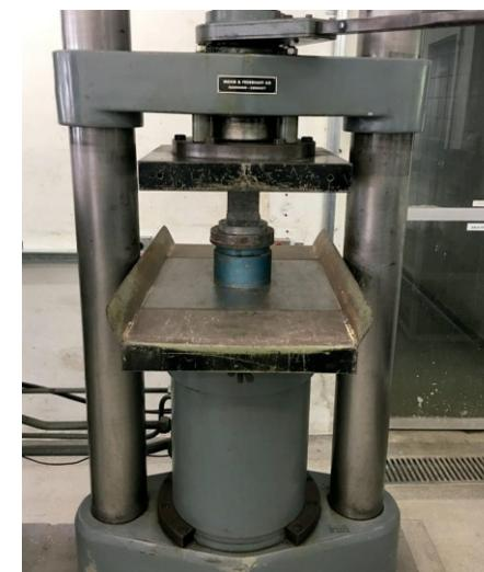
Prensa hidráulica com corpo de prova cúbico, antes do ensaio (Foto obtida no IPT).
