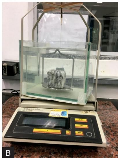
**B** (B) Determinação de peso submerso (Foto obtida no IPT).
