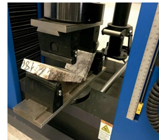
Corpo de prova rompido após a execução do ensaio (Foto obtida no IPT).
